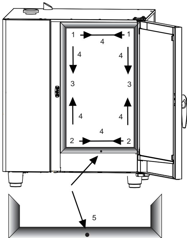
1. Ziehen Sie die alte Türdichtung langsam aus dem Montagerahmen.
