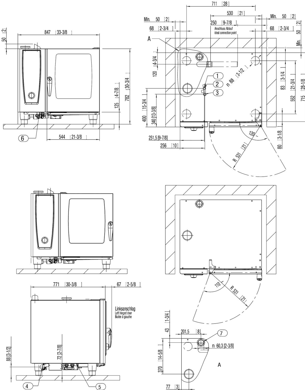
1. Gemeinsamer Wasserzulauf (Kaltwasser) 2. Wasserzulauf Kaltwasser 3. Wasserzulauf Weich- bzw. Warmwasser 4. Wasserablauf 5. Elektroanschluss 6. Potentialausgleich 7. Entlüftungsrohr DN 60 8. Mindestabstand 50 mm 9. Maße in mm (inch)
